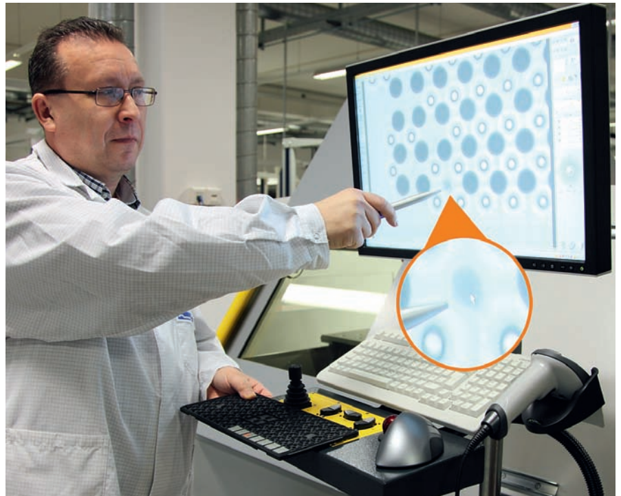
Er macht das vermeintlich Unsichtbare sichtbar: Wolfgang Motzek am Microfocus-Röntgensystem.
