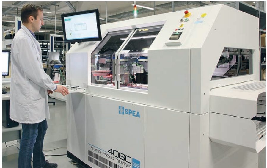
Der brandneue Flying Probe-Tester bei den ersten Testläufen durch einen geschulten Mitarbeiter.
