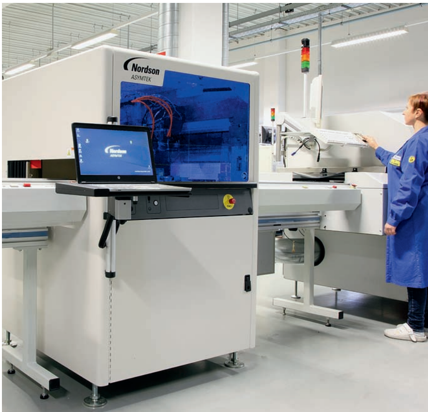
Das automatisierte Beschichtungssystem SL-940E Nordson von Asymtek bei Coronex im Einsatz.
